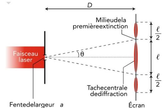
**Rappel : la relation entre la largeur  $a$  de la fente et la largeur  $l$  de la tache centrale de diffraction est :**
